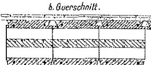
3. Eisenbetondecke mit Unterzügen und Füllungsträgern, Syst. Visintini.
